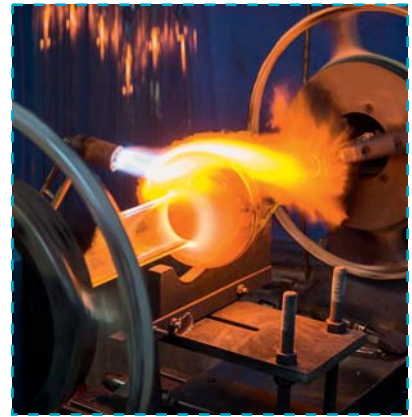
Glasröhren werden von hoch qualifizierten Glasbläsern geblasen, um die ausgezeichnete Qualität zu garantieren.
