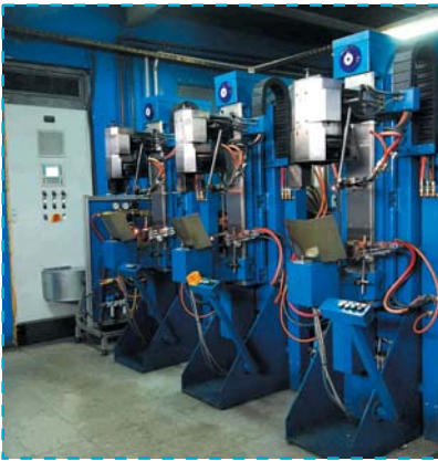
Hochmoderne Schweißmaschinen auf dem neusten Stand der Technik werden verwendet, um den Zylinderfuß anzusetzen.
