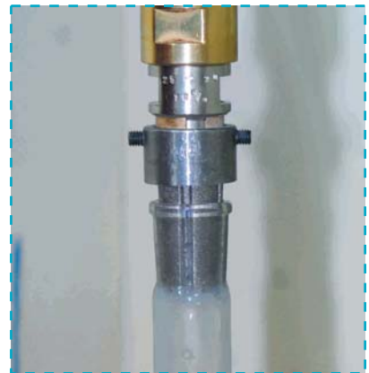
Der Schleifprozess erfolgt bei allen Normschliffen mit Diamantkegeln, die beste Resultate gewährleisten.
