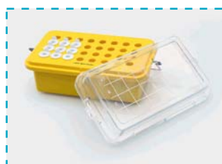
Durchsichtiger Deckel aus Polycarbonat, der die Röhrchen bei +4°C hält.
